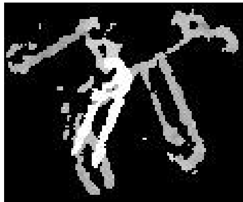
Abbildung 5.51: Darstellung der gefundenen Position mit einer zu großen Winkelschrittweite. Das hell dargestellte Objekt entspricht dem Suchobjekt in seiner gefundenen Position.
