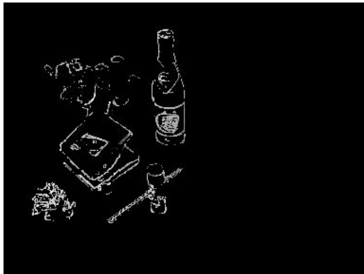
Abbildung 3.13: Disparitätsergebnis bei einer Ermittlung mit einer 3x3 Maske mit starker Bewertung der Qualität.
