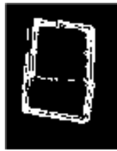
Abbildung 5.17: Die Kanten der Kunststoffbox wurden gut erkannt. Kanten, die nicht zum Objekt gehören, sind nicht zu sehen.
