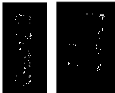
Abbildung 5.18: Das linke Bild zeigt ein Disparitätsbild der Sequenz aus Abschnitt 5.2. Das rechte Bild ist ein Disparitätsbild der in diesem Abschnitt betrachteten Sequenz. Obwohl die Objektkanten der Kunststoffbox eindeutig sind (siehe Abb. 5.17), fällt die Disparitätssuche aufgrund zu vieler ähnlicher Grauwerte schlechter aus als die Disparitätssuche in Abschnitt 5.2.
