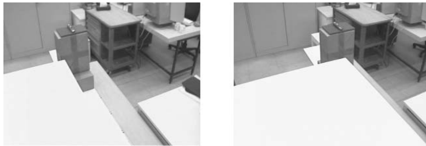
Abbildung 2.10: Verdeckung: Der Karton im mittleren Bereich des linken Bildes ist auf dem rechten Bild durch die weiße Fläche zur Hälfte verdeckt.
