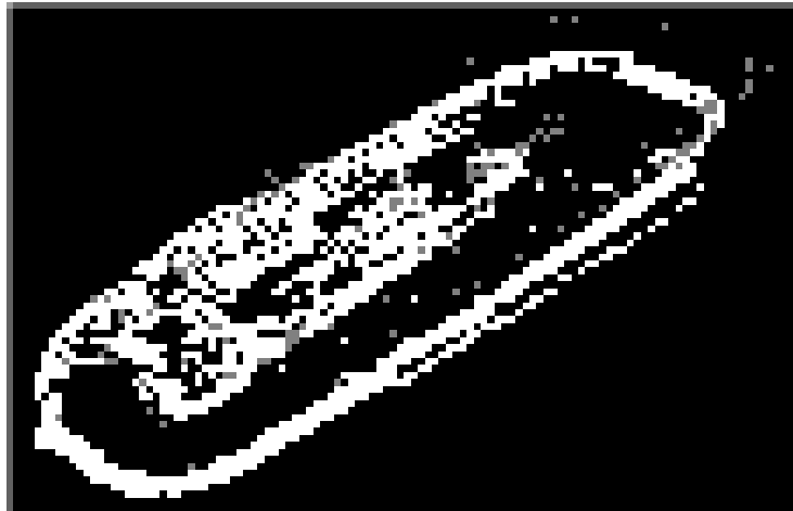
Abbildung 5.10: In dieser Abbildung ist die prädizierte Objektposition der real erreichten Objektposition anhand des Kantenbildes gegenübergestellt. Die prädizierten Pixel sind grau dargestellt, die Kantenpixel weiß. Es ist leicht zu erkennen, dass die beiden Orte gut übereinstimmen.
