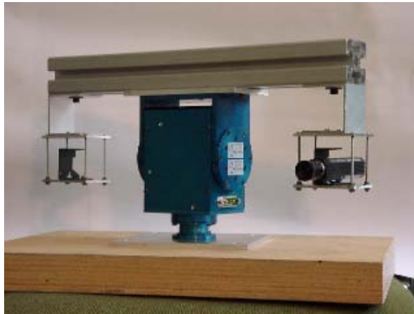
Abbildung 2.2: Kamerakopf des Verarbeitungssystems
