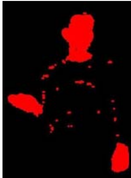
Abbildung 4.4: Ergebnisbild nach Anwendung der Opening- und Closing-Filter. Löcher in zusammenhängenden Flächen sind gestopft, isolierte Pixel entfernt.
