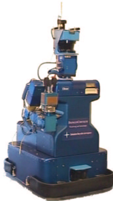
Abbildung 6: Die Experimentalplattform „Clever“. Der Roboter besteht aus einer mobilen Plattform, einem Arm mit 7 Freiheitsgraden, 2 Pentium-PC, 2 Sick-Laserscannern, 2 Farbkameras und Funk-Ethernet Anbindung.
