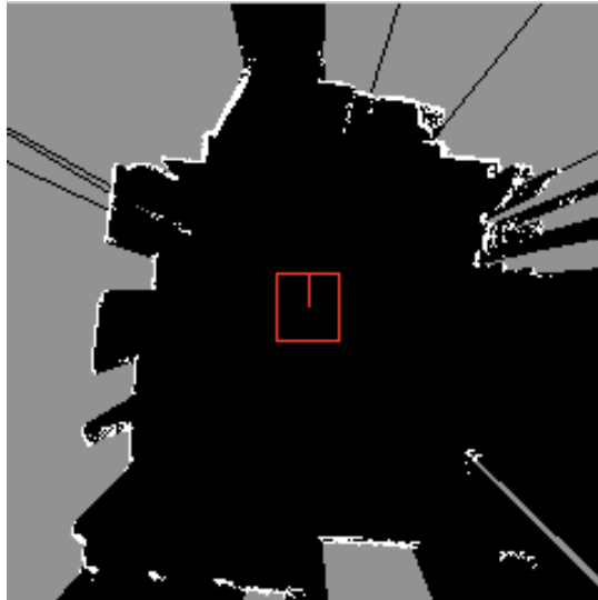
Abbildung 4: Evidenz-Gitter, das zur Zielpunktvorgabe benutzt wird. Weiß zeigt Hindernisse an, schwarz bedeutet Freiraum, grau sind Bereiche, die mit den Sensoren (noch) nicht erfasst wurden.
