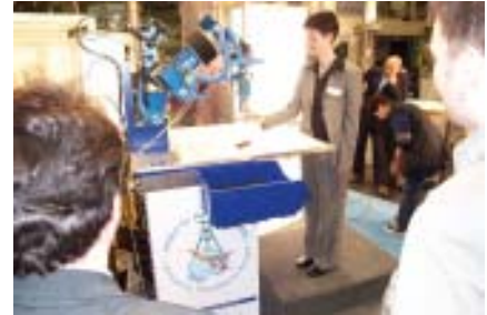
Der autonome Assistenzroboter CoRA erkennt eine menschliche Hand
