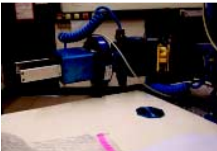
CORA mit Kraftmomentensensor. Links sieht man den Kraftmomentensensor zwischen Handgelenk und Greifer und rechts die Manschette mit der künstlichen Haut.
