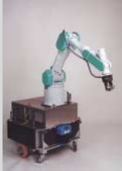
MobileArm, Basisplattform für rob@work des Fraunhofer IPA
